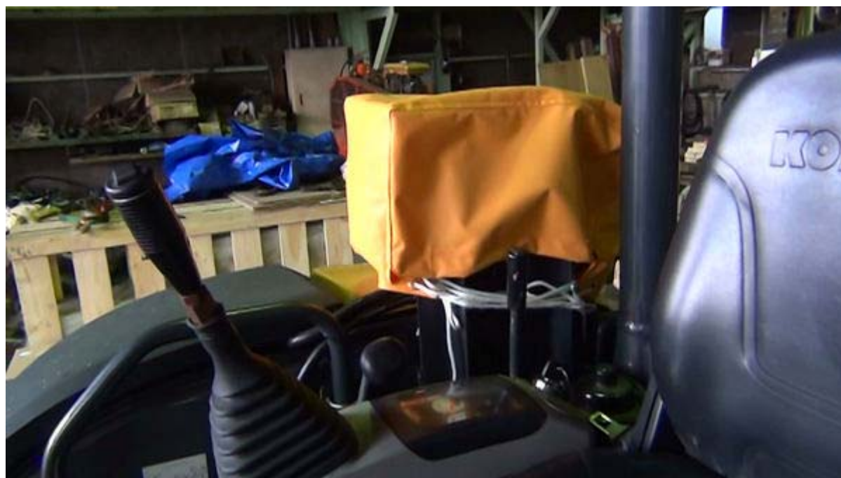
配線ボックスに布カバーをかぶせた状態
